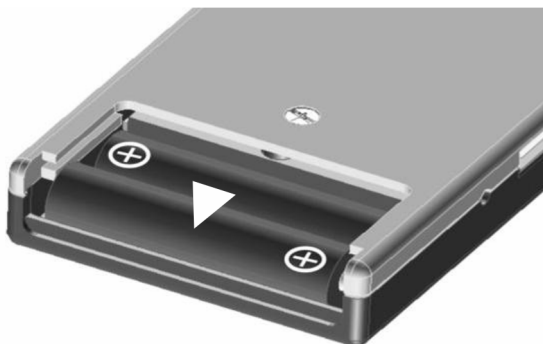
Рисунок 6.7.1 Отсек питания диктофона с установленными батареями
